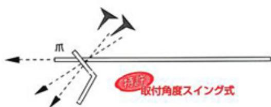
この(株)サンテック社製の内装化粧枠止め金具は、内装化粧枠に固定するビス穴が、金具の背面より外側にとび出ているので、ビス打ち作業がきわめて容易で、柱と内装化粧枠との隙間が狭い場合でも取り付け可能です。
