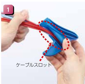
1 保護・結束する配線を専用工具HAT側面の切れ目「ケーブルスロット」から通します。
