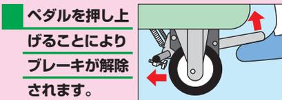
※車輪を直接ボルトで押し込む為、確実にロックされます。
