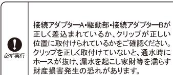
接続アダプターA・駆動部・接続アダプターBが正しく差込まれているか、クリップが正しい位置に取り付けられているかをご確認ください。クリップを正しく取付けていないと、通水時にホースが抜け、漏水を起し財家等を漏らす財産損害発生の恐れがあります。
