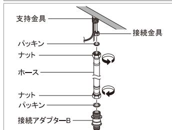
②ホースの片方のナットにパッキンを入れて接続金具にしっかりと締付けで固定し、もう片方のナットにパッキンを入れて接続アダプターBをしっかりと締付けます。
