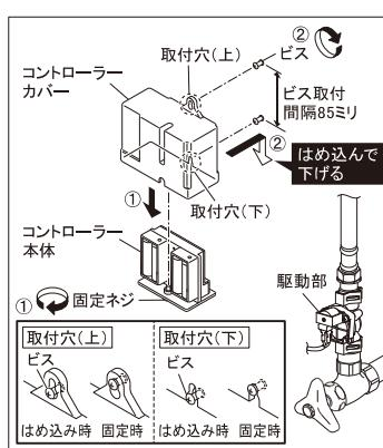
①コントローラー本体底面の固定ネジを手でゆるめ、コントローラー本体をコントローラーカバーから取出します。
