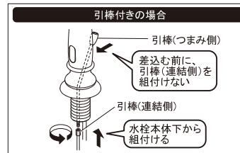
①引棒付きの場合は、先に引棒(つまみ側)を吐水部に差込みます。次に、引棒(連絡側)を水栓本体下から組付けます。
