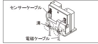
②センサーケーブルおよび電磁弁ケーブルをそれぞれコントローラー本体の溝に通します。
