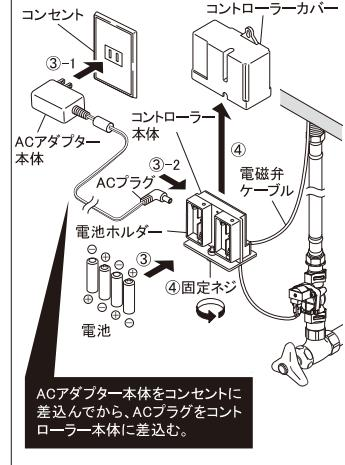
③ACアダプター本体をコンセントに差込んでから、ACプラグをコントローラー本体に確実に差込みます。電池を使用する場合は、電池をコントローラー本体の電池ホルダーに取付けます。
