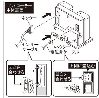
①センサーケーブルおよび電磁弁ケーブルのコネクターをそれぞれコントローラー本体の凹凸にあわせて確実に差込みます。
