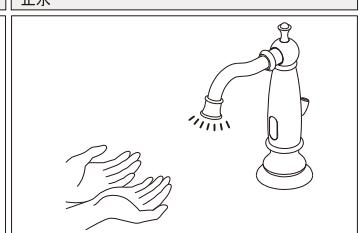
①止水栓を開き、各部に漏水がないかを確認します。
