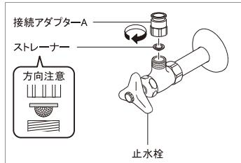
①ストレーナーの網が出ている方を止水栓側に向けて接続アダプターAに入れ、接続アダプターAを止水栓にしっかりと締付けます。
