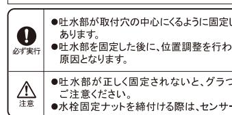
●吐水部が取付穴の中心にくるように固定してください。偏って取付ると、確実に固定されない恐れがあります。
