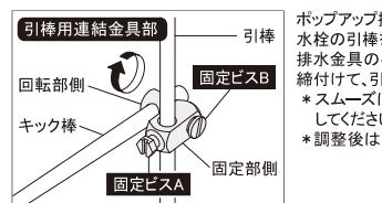
キック棒を操作するために、排水金具のキック棒と水栓の引棒を接続します。
