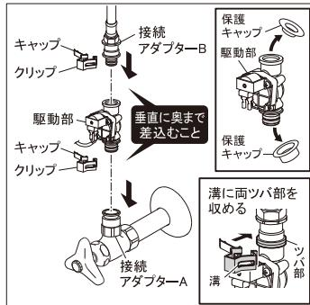
③駆動部の保護キャップを外します。接続アダプターAに駆動部・接続アダプターBの順に垂直に奥まで差込みます。
