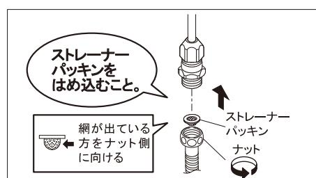
④網が出ている方をナット側に向けてストレーナーパッキンをホースのナットにねじ込んでから、銅管用アダプターに「レンチ」などでしっかりと締付けて固定します。
