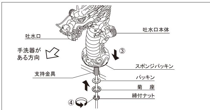
①吐水口本体を設置する場所の取付穴径を確認し、穴周囲の汚れを取ります。
