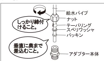
②給水パイプにナット、テーパリング、スペリワッシャ、パッキンの順に通してから、アダプター本体を給水パイプに垂直に奥まで差込み、ナットを手で締付けます。
