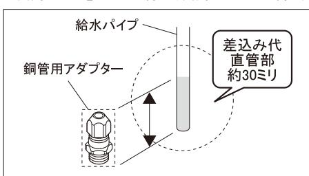
①給水パイプの必要長さを確認し、切断します。
