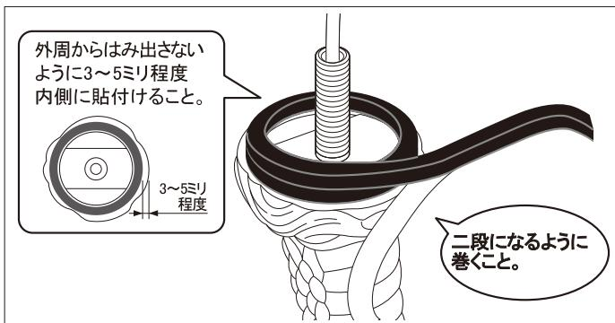
吐水口底面の外側寄りに、イラストのようにスポンジパッキンを二段に貼付けます。
