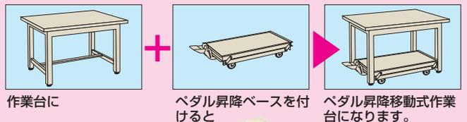
作業台にペダル昇降ベースを付けると、ペダル昇降移動式作業台になります。
