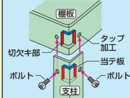
支柱内側の当て板を棚板切欠キ部にはめ込み赤色部分で支柱と棚板が突き合わせり、横揺れを軽減します。青色部分で上からの荷重を支えます。
