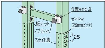
ノブボルト付金具の採用により天板からの衝撃に強く、又、板ナットとボルトにより、ぐらつき防止の高い強度を確保しています。
