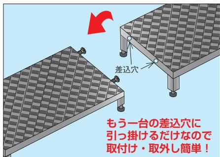
もう一台の差込穴に引っ掛けるだけなので取付け・取外し簡単!
