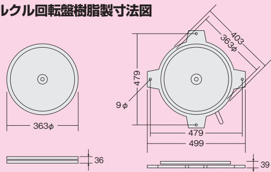
※本体材質の強化樹脂(ABS)は非常に軽く、また耐衝撃強度を持ち(落としても割れにくい)、耐水性、耐薬品性、耐熱性(70℃~100℃)にも優れています。
