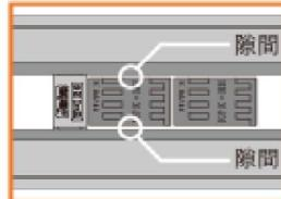
120mm幅の気密パッキン(KPK-N120、KPK-VN120、KDP-120)にKPKN補助板を施工する場合、気密パッキンとKPKN補助板の間に隙間ができますが、性能上問題はありません。
