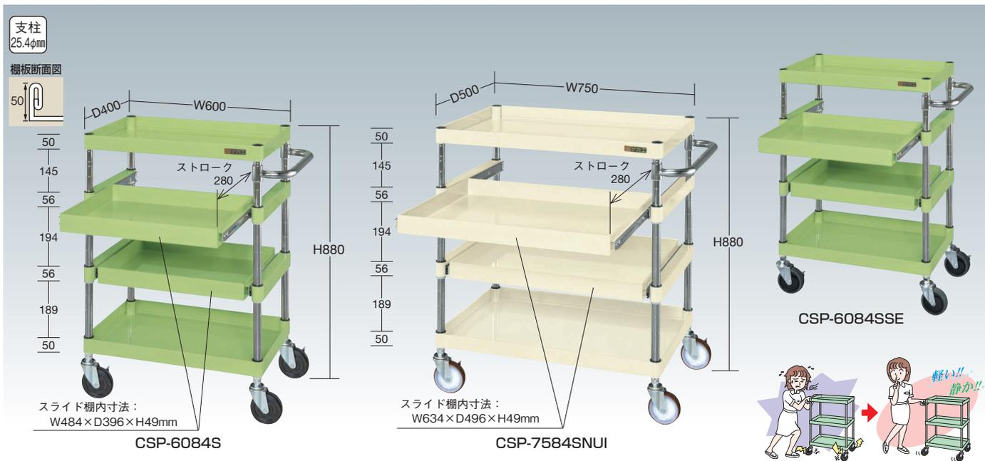
●棚板厚: CSP-6084=0.8mm, CSP-7584=1.0mm ●スライド棚2段 (50mmピッチで段替え可能) ●スライド棚板厚: 1.0mm (単位: mm)
