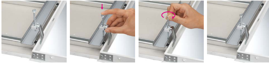
①ハンガーを外枠にセットします。②ハンガーボルトを取付野縁に当たるところまでスライドさせます。③ハンガーボルトを数回回し締めます。④完了
