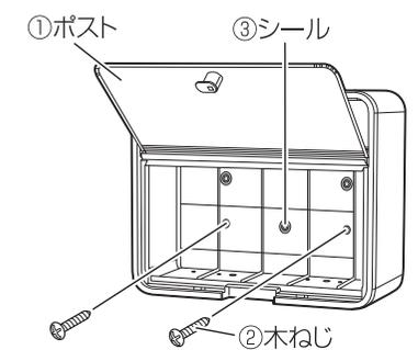
柱に取り付ける際は下段中央の穴を、壁に取り付ける際は下段左右2ヶ所の穴を使用し、②木ねじで①ポストを固定してください。最後に②で仮止めした②木ねじをしっかりと固定してください。
