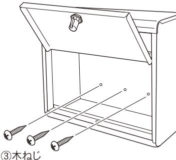
下部のねじ穴に残りの3本の③木ねじで①ポストを固定してください。
