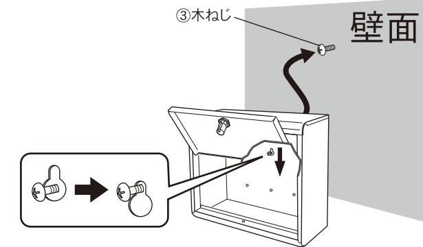
③木ねじを壁面に仮止めし、①ポスト上部の穴をかけてください。
