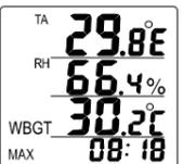
記憶された最高値/最低値をクリアするには、裏面のMIN/MAXボタンを2秒以上押ししてください。表示が全点灯し、記憶された最高値/最低値がクリアされます。注意：電源スイッチ①で電源をオフしたり、本機をリセットすると記憶された最高値/最低値がクリアされますのでご注意ください。
