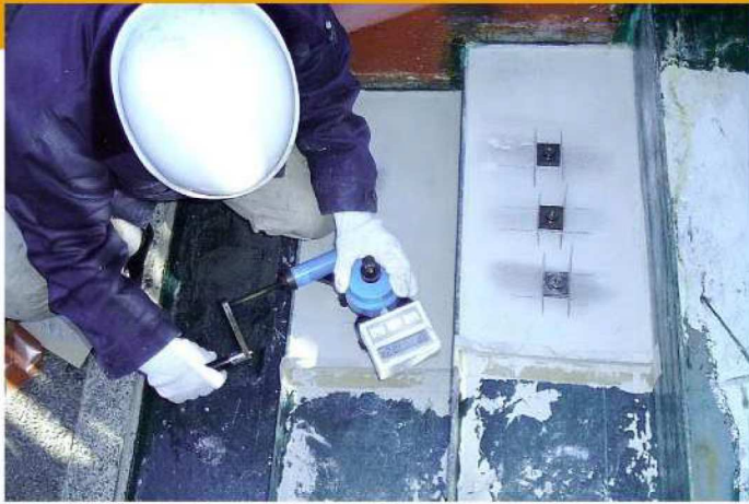
マノールポリマー#1000接着力試験状況
