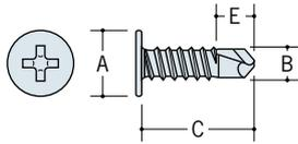
鉄板 (鉄骨) + 薄鋼板
