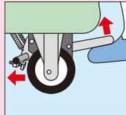
※車輪を直接ボルトで押し込む為、確実にロックされます。
