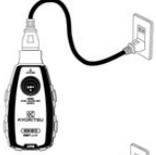
200V用コンセントの場合はプローブピン付コードセットを使用
