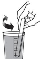
A液とB液を付属のかくはん棒で30秒間よく混合します。内面に付着した液もこするようにかくはん棒で混ぜ、できるだけ気泡を巻き込まないように十分に混合してください。
