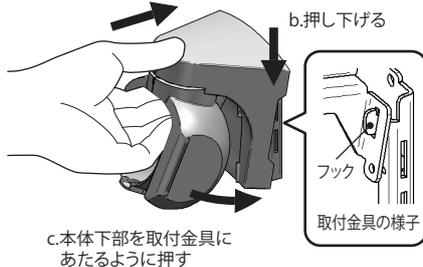
④取付金具のねじ穴が見えるように調整してください。
