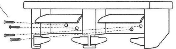
①製品が水平になるよう位置決めし、壁取付面の取付穴をけがいてください。
