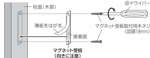
△注意 マグネット受板を固定する時、マグネット受板取付用木ネジの頭が飛び出さないようにしてください。
