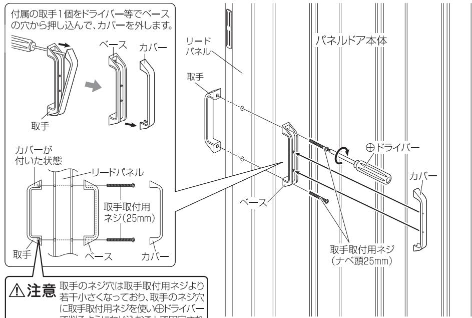
**△注意** 取手のネジ穴は取手取付用ネジよりも若干小さくなっています。取手のネジ穴に取手取付用ネジを使い $\oplus$ ドライバーで削るようにはめ込むことで固定されます。そのため取手のネジ穴にはネジ山はありません。
