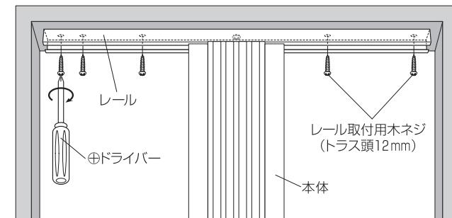
△注意 レール取付用木ネジの入数は、最大の寸法分の数量ですので取り付け幅に応じてご使用ください。又、レールを固定する時レール取付用木ネジの頭が飛び出さないようにしてください。
